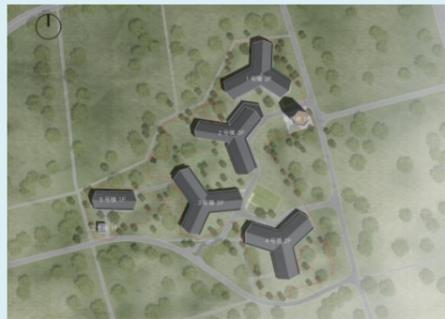
“青苗”的得名，来自建筑的仿生设计——从建筑几何中心，按 $120^\circ$ 夹角向三个方向各自生长出一组拱形木构屋盖，形成三叶草的形态。屋盖为叶，木梁为脉，连接为节。原初概念贯穿整个设计过程，由“青苗”的中心向三个方向延伸出木结构构架，构筑出自然、温暖、舒适的内部空间。
