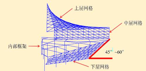
为验证结构的可靠性，进行了考虑初始几何缺陷及材料弹塑性的结构稳定性计算，并采用NIDA进行直接分析法的补充验算，解决了局部构件出现的应力比超限情况。
