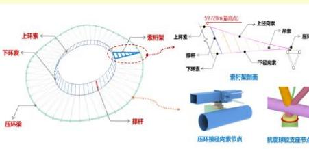
体育场场芯、吊顶、立面均采用 PTFE 膜结构，膜总用量约 4.4 万 m<sup>2</sup>，其中场芯膜为高透光率 PTFE 网格覆盖膜，吊顶、立面膜均为网格膜。场芯 PTFE 膜结构位于索结构上部，膜材为以玻璃纤维为基布的 PTFE 涂层网格防水膜，共 48 片膜材，膜面长度约为 43m。是目前世界最大单层 PTFE 网格覆盖膜结构工程，也是世界上首个平面单层膜的轮辐式索膜结构体系。
