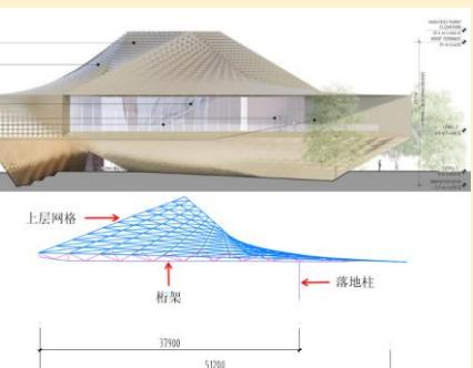
下层网格大角度外倾，在竖向荷载作用下，外倾的下层网格会使二层水平构件受到较大的拉力。为防止二层楼板拉裂，要求二层混凝土在下层网格的临时支撑拆除后方能浇筑，保证竖向荷载作用下的拉力全部由二层钢梁承担。二层钢梁的布置以垂直于下层网格为主，将水平拉力有效传至内部框架。
