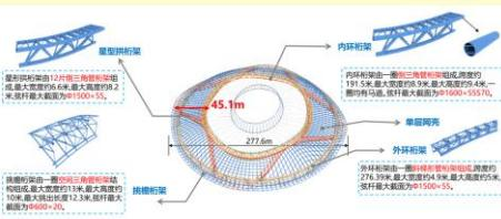
轮辐式索桁架(157×177m)由上下 2 道环索、48 榻径向索桁架和压环梁组成，属于全张力自平衡结构体系，索桁架周边支承在压环梁(Q460GJC)上，压环梁通过抗震球铰支座与外圈钢结构连接。
