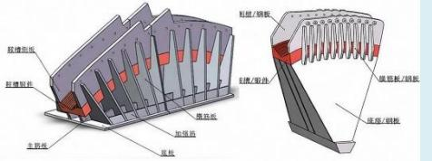
锻焊式索鞍的鞍槽底板 30CrMo 钢锻件，侧壁及底座由 Q420qE 钢板焊成，相比铸焊式索鞍而言，主索鞍降低质量 25.6%，散索鞍降低质量 30.5%，实现了结构轻型化。
