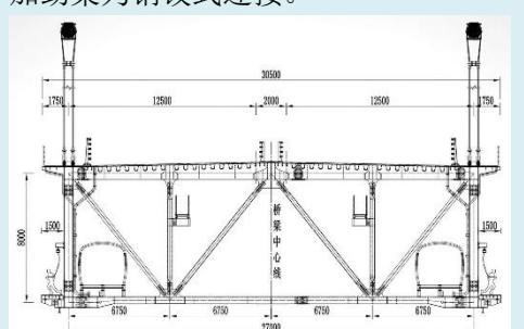
加劲梁采用板桁结合钢桁梁，由主桁、横梁、桥面板、下平联组成。主桁架为带竖腹杆的华伦式结构，主桁高 8m，桁宽 27m，标准节段长度 15.4m。
