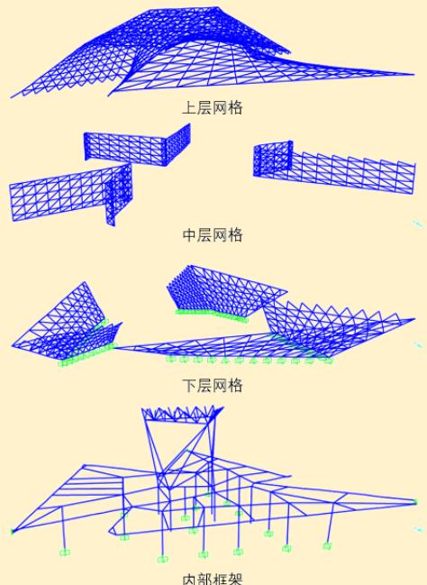
屋面采用玻璃+铝板的双层幕墙系统，要求上层网格的变形控制在1/400，而上层网格对应的阳台跨度为51.2m，且阳台玻璃立面区域不能设置竖向构件。
