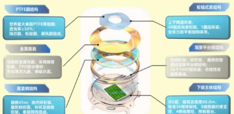
钢结构由下部钢结构及屋盖钢结构两部分组成，下部钢结构由钢骨柱、圆管柱、框架梁，以及最大悬挑约 18m 的观景平台钢桁架组成。屋盖钢结构采用桁架和单层网壳组成刚性结构体系，由内、外环桁架、星形拱桁架、单层网壳、挑檐桁架组成，大量使用 Q420GJ、Q460GJ 等高强钢材料。屋盖钢结构外环桁架下弦杆通过 36 个抗震球铰支座与底部的排架柱连接，并设置 8 组柱间屈曲约束支撑和 4 根摇摆柱。柱间屈曲约束支撑与排架柱和外
