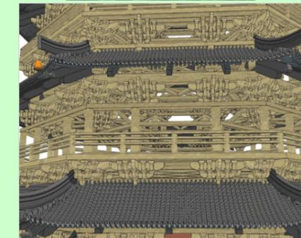
首层之上是一种由支撑木构成的环状结构，该结构被屋檐遮挡从外部无法看出，形成暗层，暗层之上再铺设梁、柱、枋以及斗拱，是为明层。暗层明层结合便是木塔的第二层。之后各层亦按此方式复制叠加，最终形成了五明四暗的塔身。四个暗层有如四道金箍，可以有效约束塔身，防止变形。
