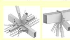
径向桁架由主檩条和次檩条相连,主 檩条还起到铺设屋面夹层板的作用。主檩 条两侧由销轴连接。除了伸缩缝外, 销轴 孔均为普通圆孔,传递径向桁架间的水平 力。屋面结构布置有7条伸缩缝,伸缩 缝处的主檩条一侧普通圆孔、另一侧长圆 孔,用以释放温度应力。次檩条只起铺设 屋面夹层板的作用。次檩条一侧栓接、另 一侧销轴连接, 销轴连接孔为长圆孔。
