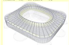
体育场沿南北轴和东西轴双轴对 称。屋面投影边长 225mx194m, 中心开 孔尺寸约 125mx85m。屋面钢结构由径 向桁架、压环、拉杆环、钢柱、交叉 拉杆、下弦檩条六部分组成。48 根钢 柱沿体育场周边布置, 径向桁架长度 55m到 78m 不等。柱顶、柱底为单向铰, 可绕环向切线转动。整个体育场共设 八个开间的双层柱间支撑Φ120mm, 东 西南北四面各2个。
