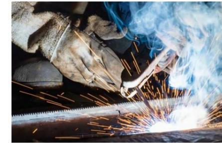
但是，当时的人们并不知道，焊接时会产生单原子氢，而单原子氢会钻入金属中形成氢气。氢气在金属晶粒附近聚集起来，破坏金属的结构，让金属胀气变脆，这个现象被命名为氢脆。有时氢气在金属内能累积成 18.7 兆帕，也就是地表气压 187 倍的高压。此外在高温下，被钢铁吸收的氢原子还可能和钢材中的碳原子形成甲烷气体（CH<sub>4</sub>），使钢材脱碳变脆，这被称为氢腐蚀。
