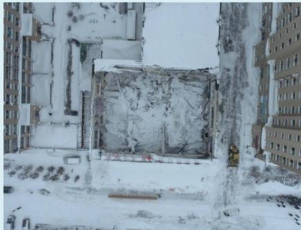
极端寒潮天气仍在影响我国南方地区。受极端寒潮天气影响，多地铁路列车、航班停运或延误；大跨度钢结构的集贸市场、超市、农户大棚出现坍塌，引发一定伤亡。2月21日10时10分左右，湖北省随州市发布消息，随县万和镇神农超市部分顶棚被雪压垮，1人受伤经抢救无效死亡，目前，垮塌原因正在进一步调查中。此外，湖南省常德、益阳、张家界及河南等地也发生了几起因积雪覆盖导致建筑物坍塌事故。此前，北方地区一些大跨度钢结构建筑曾受极端天气影响引发重大伤亡事件，教训惨痛。
